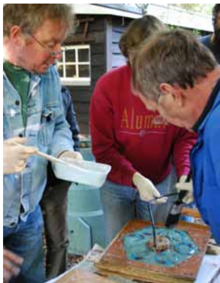
Het gieten in kunststof hars van de spoelen.
