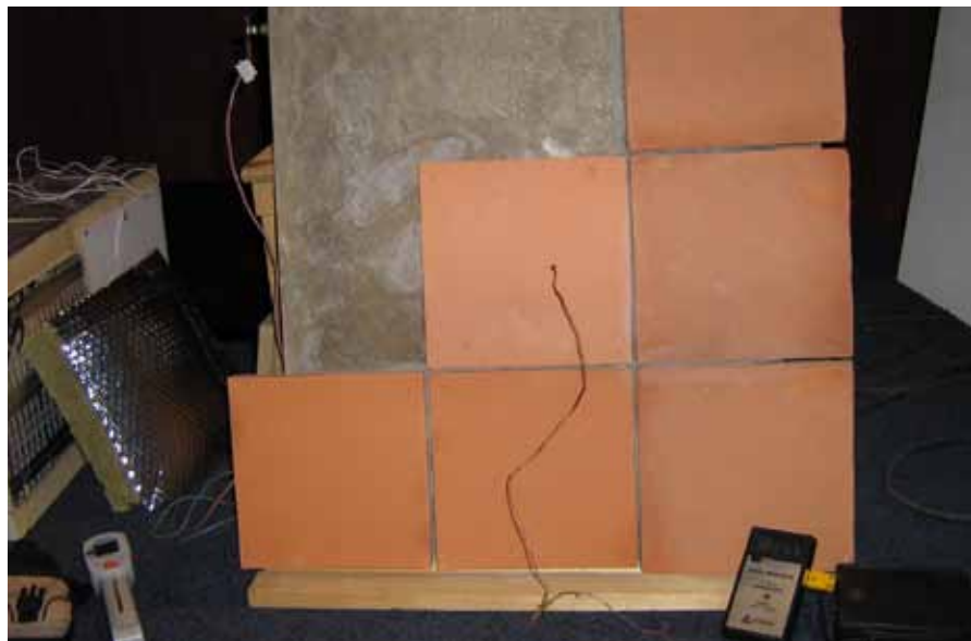
De gedeeltelijk met tegels beklede elektrisch verwarmde Fin-ovenwand met naar het midden lopende verbindingdraad naar temperatuursensor. De inwendige temperatuur bedroeg na 1 uur ruim 90 graden; maximaal wordt 210 graden gemeten.
