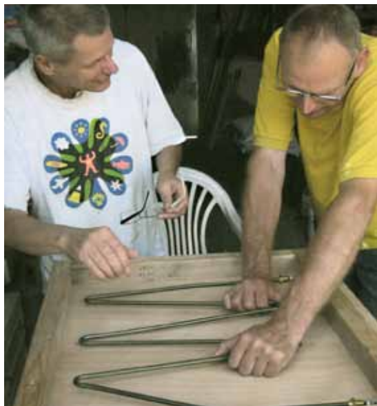
Matthieu en Dirk plaatsen het eerste thermo-elektrische profelement in de gietmal van een kachelwand.
